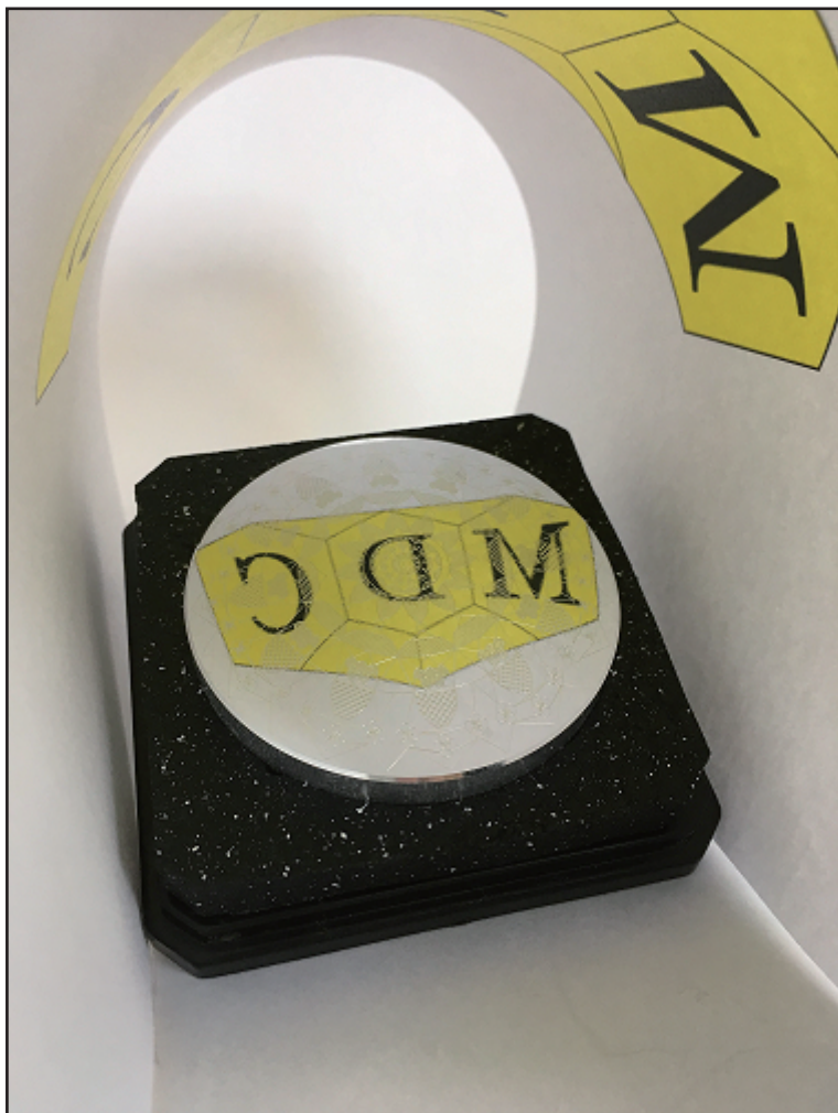
磨きレス微細模様および鏡面切削加工（被削材：アルミ） Micro patterning and mirror finishing without polishing (work : alminum)
